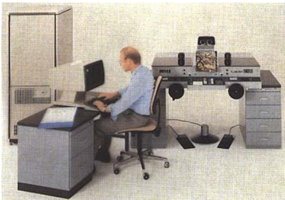
Obr.8.16 Příklad analytického stereoplottteru
