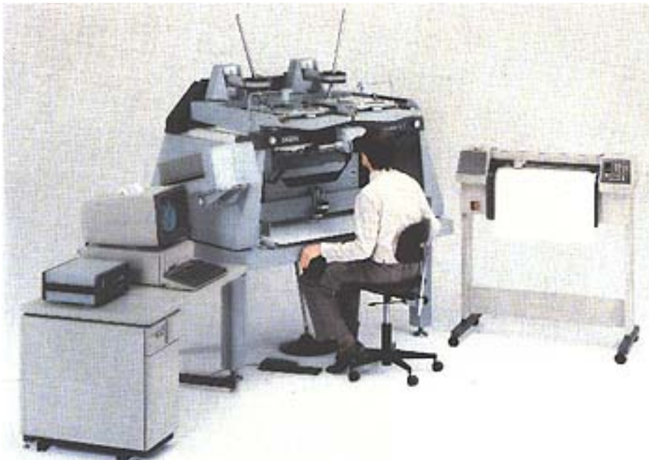
Obr. 8.15 Příklad analogového přístroje s mechanickou projekcí
