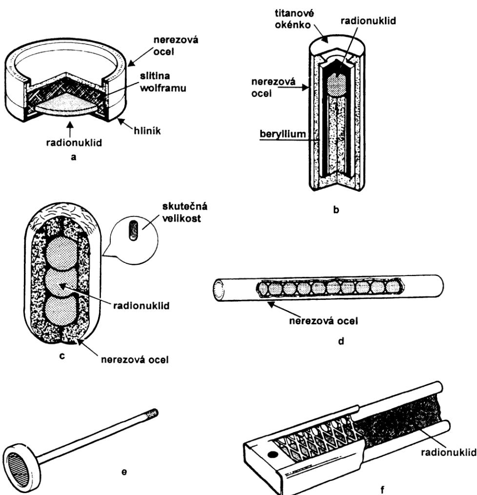
Provedení některých typů radionuklidových zdrojů ionizujícího záření (bližší popis v textu). Převzato z [6].
