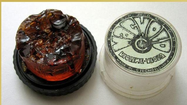
**Kalafuna** je destilační zbytek z pryskyřice borovic, nebo získávaný při výrobě buničiny. Chemicky jde o směs slabých organických kyselin. Při pokojové teplotě je nerozpustná ve vodě, s vysokým izolačním odporem a netečná vůči kovům. Taje mezi 60–80 °C, plně tekutá při 120 °C. V horkém stavu reaguje jako silná kyselina.
