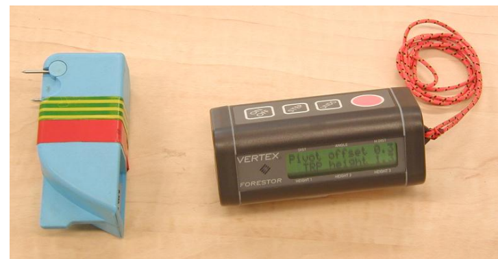
Výškoměr (Forestor-Vertex, Elpa, Finsko) - slouží k měření výškového přírůstu stromu.
