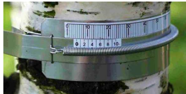
Mechanický dendrometr (EMS, Brno, ČR) – slouží k měření tloušťkového přírůstu kmene v průběhu vegetační sezóny.
