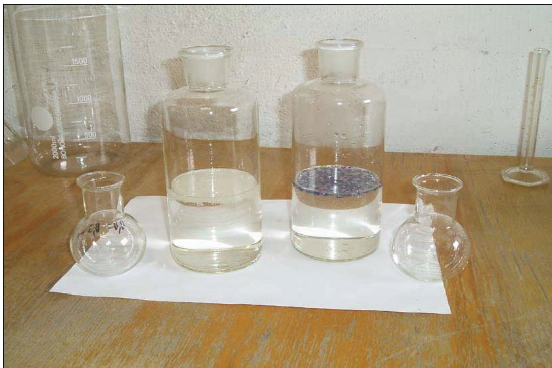
Obr. č. 4 – Plovoucí shluk „spečených zrn zatěžkávadla“ zrnitostní třídy 0,0 – 0,5 mm (bezbarvý PET) a 0,0 – 0,3 mm (neseparovaný barevný PET)
