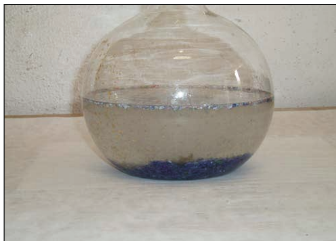
Obr. č. 3 – Samorozdružovací efekt v suspenzi PET, zrnitost zatěžkávadla 0 – 4 mm
