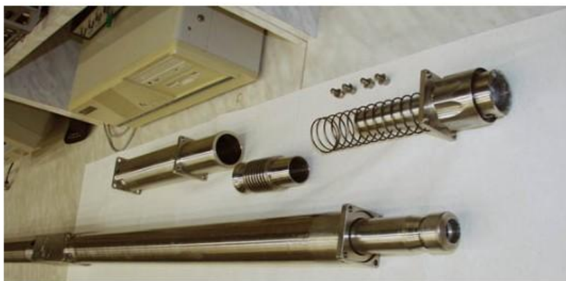
Rozebraná regulační tyč UR-70 při provozní kontrole
