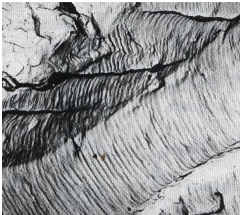
Obr.12.13. Mikrofotografie lomu hliníku (s charakteristickým žlábkováním) [ 2 ].
