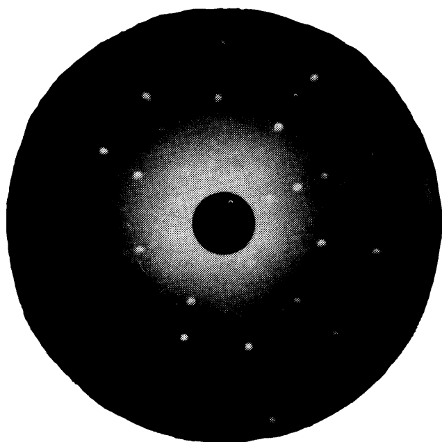
Obr. 2.5. Lauegram monokrystalu Cu orientovaného ve směru [111]
