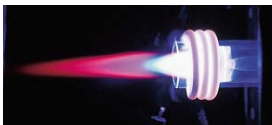
Obr. 4.2: Plazmový hořák. Tři bílé závity v pravé části obrázku jsou budící cívka
