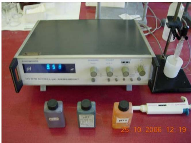
Vložíme-li elektrodu do roztoku lze odečíst napětí v  $mV$  nebo  $pH$ . Napětí je měřeno přesně. Hodnota  $pH$  je přesná, je-li přístroj správně zkalibrován. Elektroda je připojena a display přístroje udává měřenou hodnotu, až po zapnutí tlačítka „M“ stlačením. Při manipulaci s elektrodou a pokud neměříme je vhodné vypnout měření knoflíkem **M** (na displeji se zobrazí nula).
