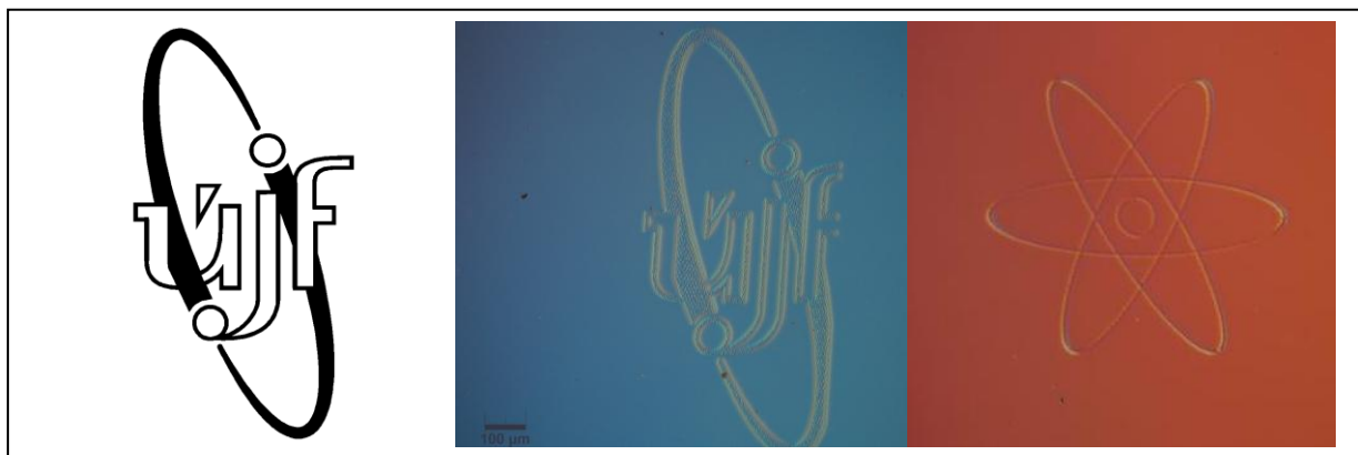
Obrázek 7 Vzor loga a jeho obraz napsaný v rastrovém modu ionty uhlíku a schematický obraz atomu kyslíku psaný ve vektorovém modu ionty kyslíku do tenké vrstvičky PDMS.
