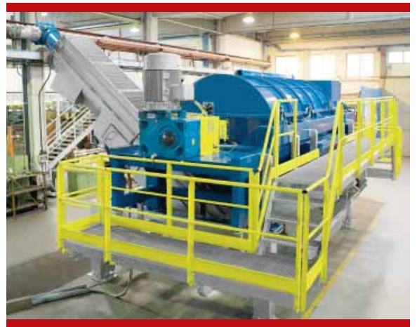
Prelavaggio a freddo ad alta frizione High friction cold prewashing
