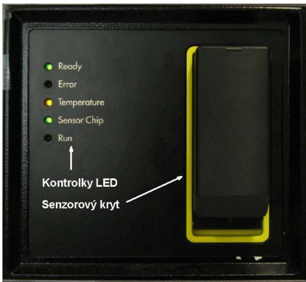
Obr. 6: Panel s kontrolními LED a senzorovým krytem
