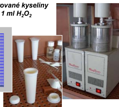
Uniclever microwave digestion unit (Plazmatronika, Wrocław, Poland) 20 min, výkon 100 W (max. 2.6 MPa, 250°C)
