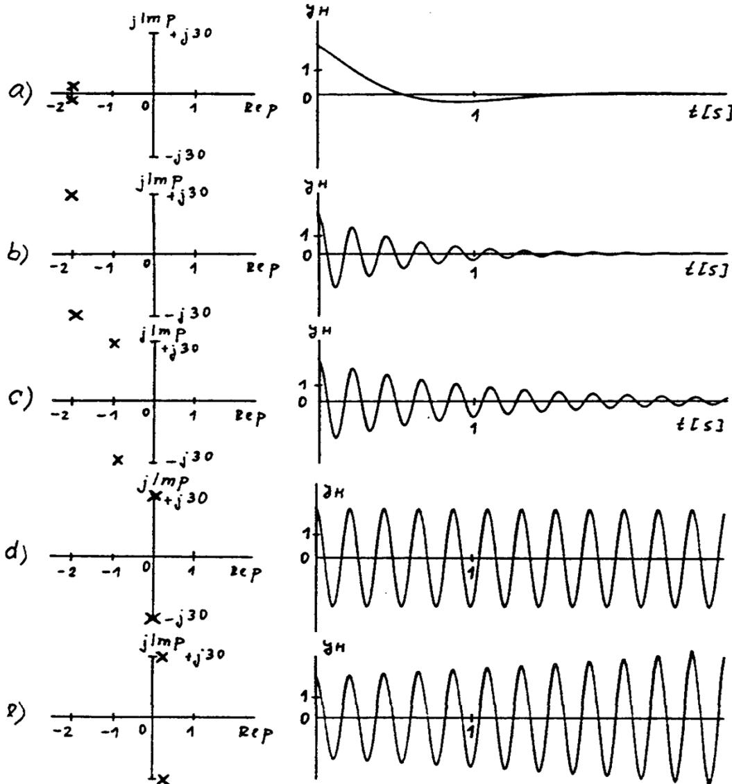
Přirozená odezva systému 2. řádu pro různá rozložení komplexních pólů a integrační konstanty  $C_1 = C_2 = 1$ .
