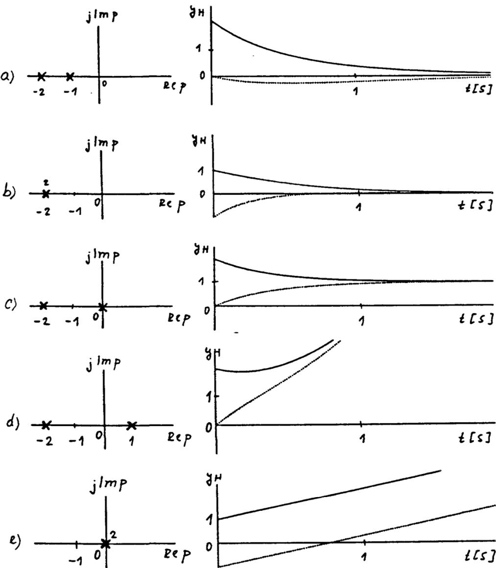
Přirozená odezva systému 2. řádu pro různá rozložení reálných pólů a různé integrační konstanty  $C_1$  a  $C_2$ . Plná čára:  $C_1 = C_2 = 1$ . Tečkovaná čára:  $C_1 = -1$ ,  $C_2 = 1$ .
