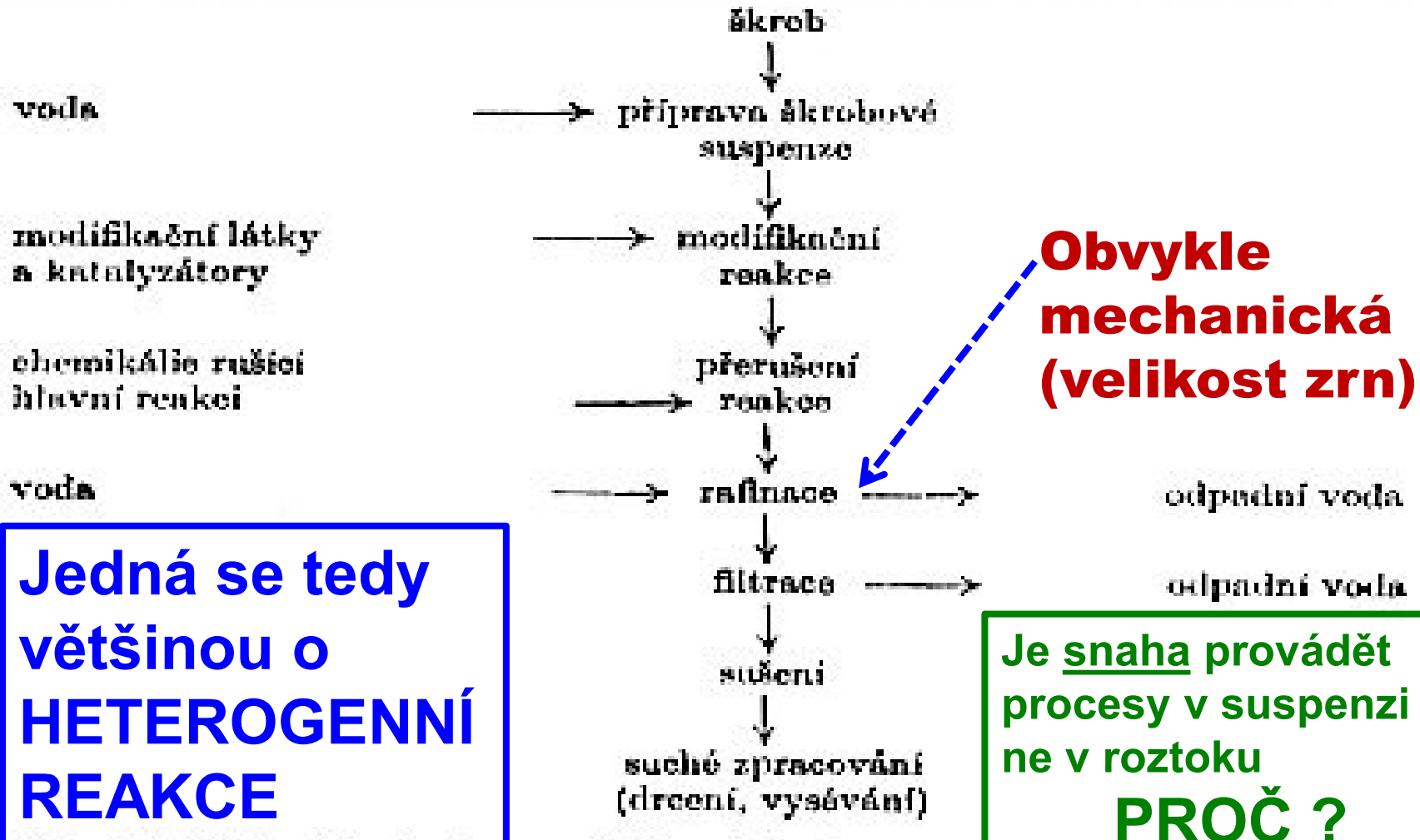
Obr. 26. Základní schéma modifikací škrobu
