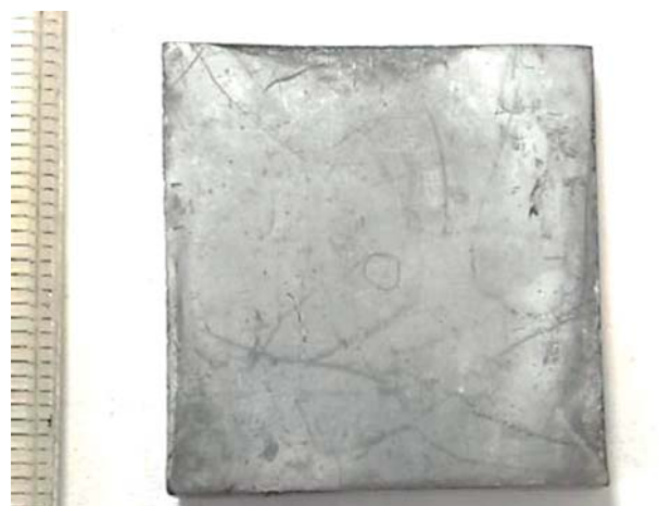
Obr. 5. Uměle korodovaný olovený kupón, na který byl aplikován dekanóát sodný o koncentraci 0,01 mol/l ponořením na 24 h [15]
