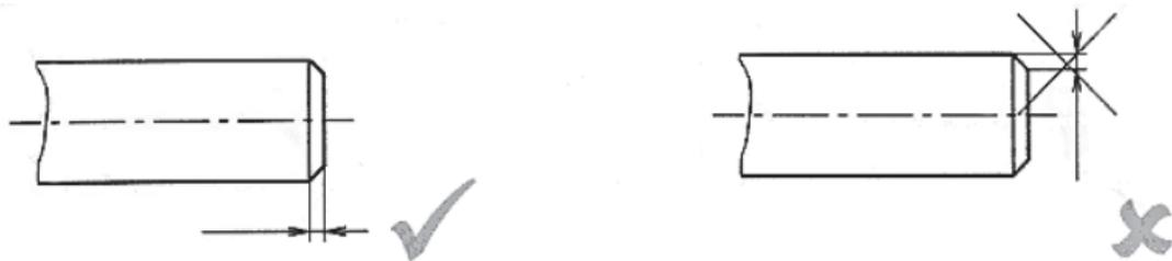
Hrany zkosené pod úhlem  $45^\circ$  se kótují součinem velikosti zkosení a úhlu  $45^\circ$ . Malá nezobrazená zkosení se mohou kótovat na/k odkazové čáře ukončené šipkou směřující proti zkosení.
