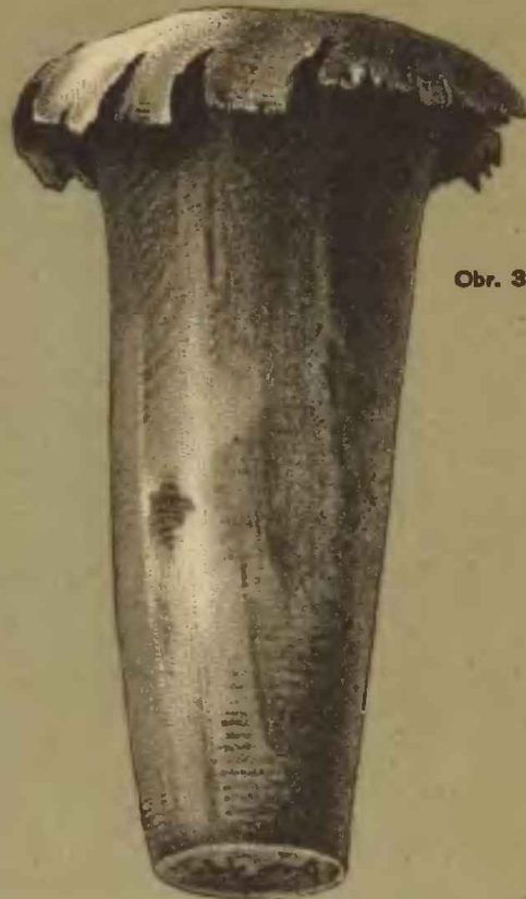
Obr. 3a. a b. Spodní a svrchní kolek na památní peníz císaře Maximiliana I. k razbě pod kladivem. (Dle originalu v c. k. říšské mincovně ve Vídni.)
