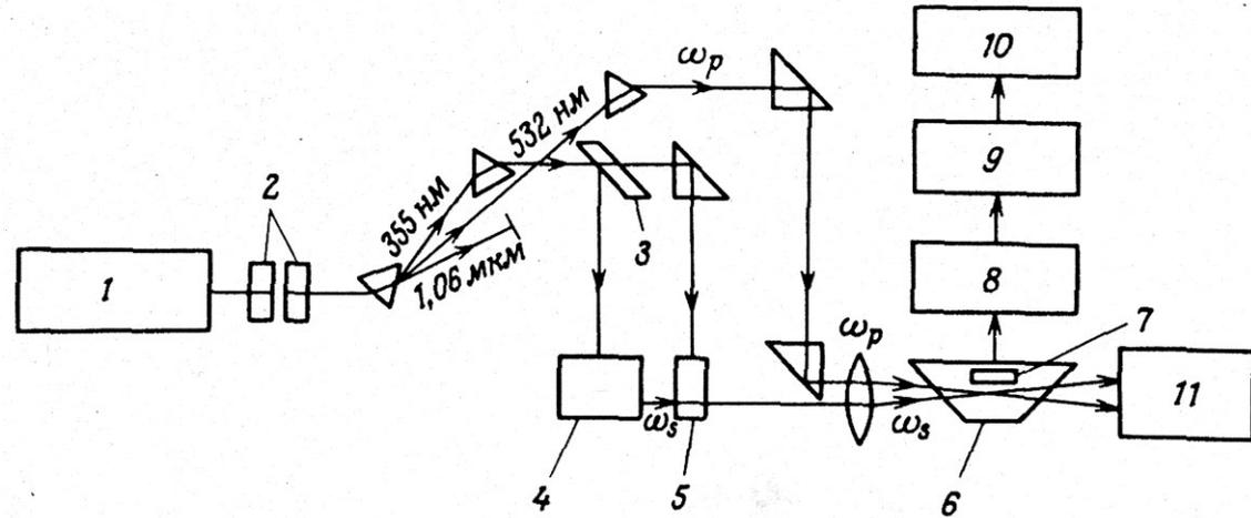
Рис. 1.8. Схема эксперимента по импульсной фотоакустической спектроскопии усиления комбинационного рассеяния (ФАСУКР) [412]: 1 — Nd — YAG-лазер; 2 — нелинейные дейтерированные кристаллы KD\*P; 3 — разделитель пучка; 4 — генератор на красителе; 5 — усилитель на красителе; 6 — фотоакустическая ячейка; 7 — микрофон; 8 — усилитель; 9 — строб-интегратор; 10 — самописец; 11 — измеритель мощности.
