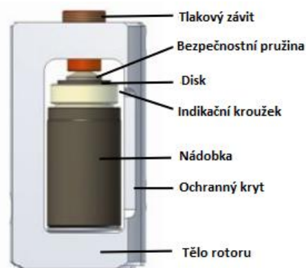
Obr. 6 Kompletní segment pro rozklad jednoho vzorku
