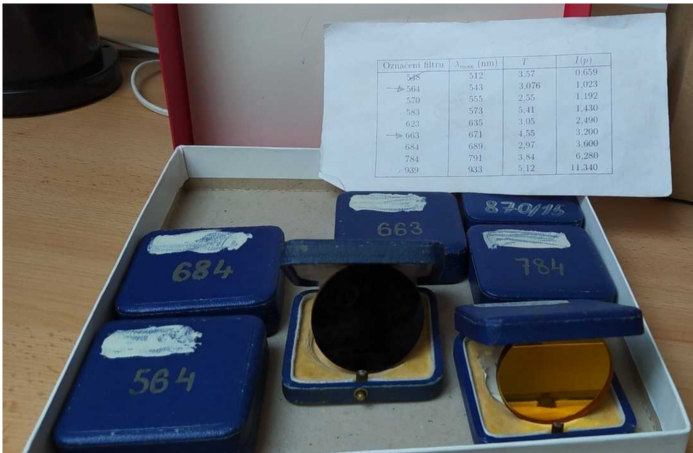
Obr. 10: Sada sada barevných filtrů s tabulkou vlnových délek pro které mají jednotlivé filtry maximální propustnost
