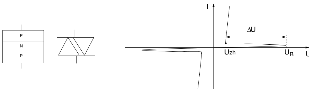
Obrázek 6.1: Vlevo – schéma uspořádání a symbol diaku. Vpravo – voltampérová charakteristika diaku.
