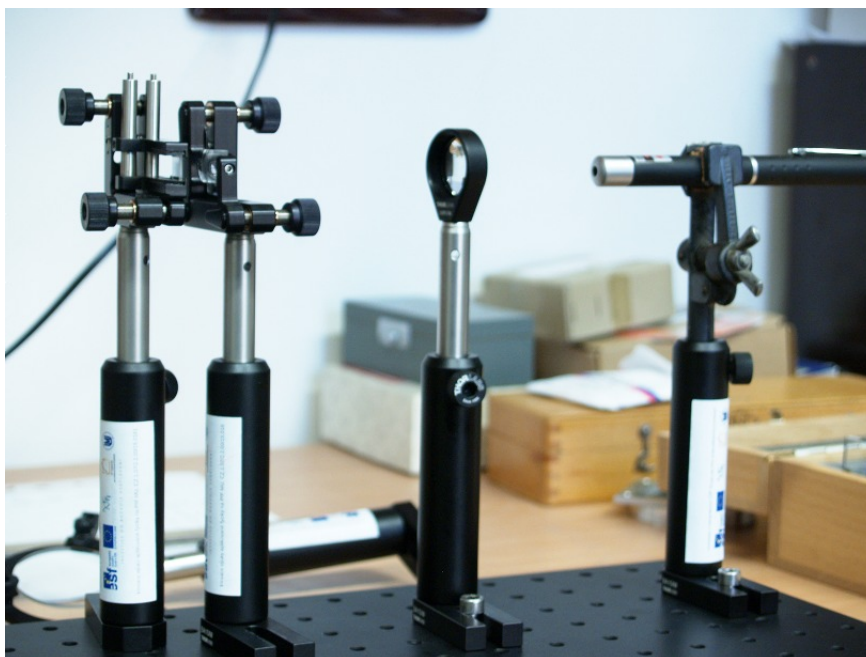
Obrázek 3: Konstrukce optické cesty na optické lavici.
