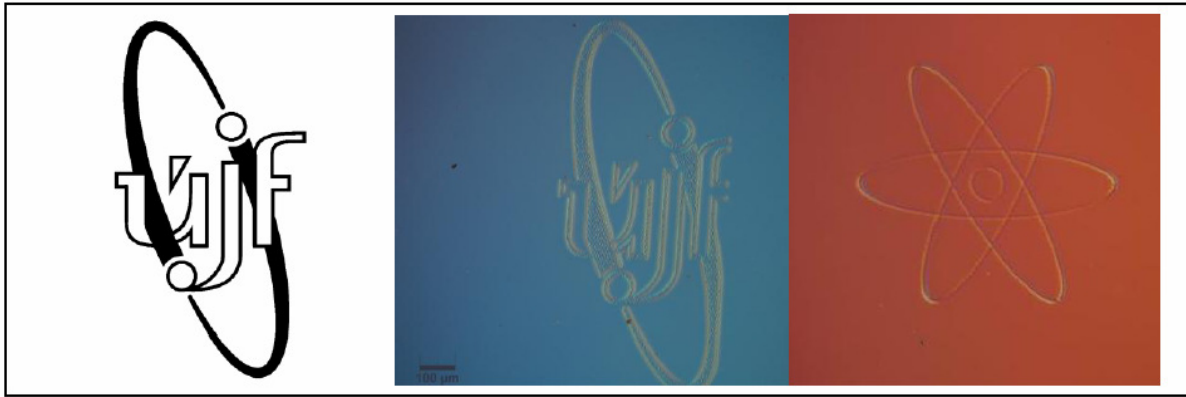
Obr. 7 Výsledek psaní ionty 12 \text{ MeV O}^{5+} do vrstvičky silikonu nanesené na skle. Rozměr loga ústavu psaného bitmapovou technikou je 1 \text{ mm} . Atom kyslíku byl psán vektorově a měří v průměru cca 400 \mu\text{m} . Doba psaní se pohybovala v řádu jednotek minut při proudu okolo 30 \text{ pA} .
