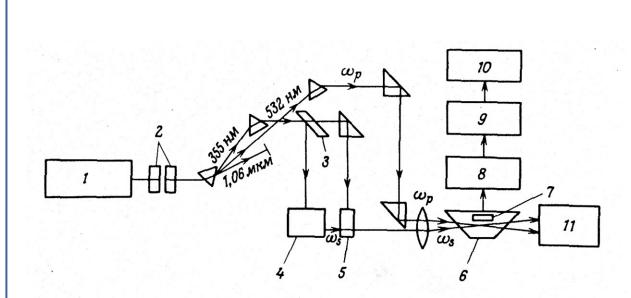
Рис. 1.8. Схема эксперимента по импульсной фотоакустической спектроскопии усиления комбинационного рассеяния (ФАСУКР) [412]: 1 - Nd - YAG-лазер; 2 - нелинейные дейтерированные кристаллы KD\*P; 3 - разделитель пучка; 4 - генератор на красителе; 5 - усилитель на красителе; 6 - фотоакустическая ячейка; 7 - микрофон; 8 - усилитель; 9 - строб-интегратор; 10 - самописец; 11 - измеритель мощности.
