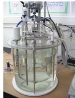
**Průtočný míchaný reaktor** – díky průtoku dochází k ustálení stacionárního složení reakční směsi.
