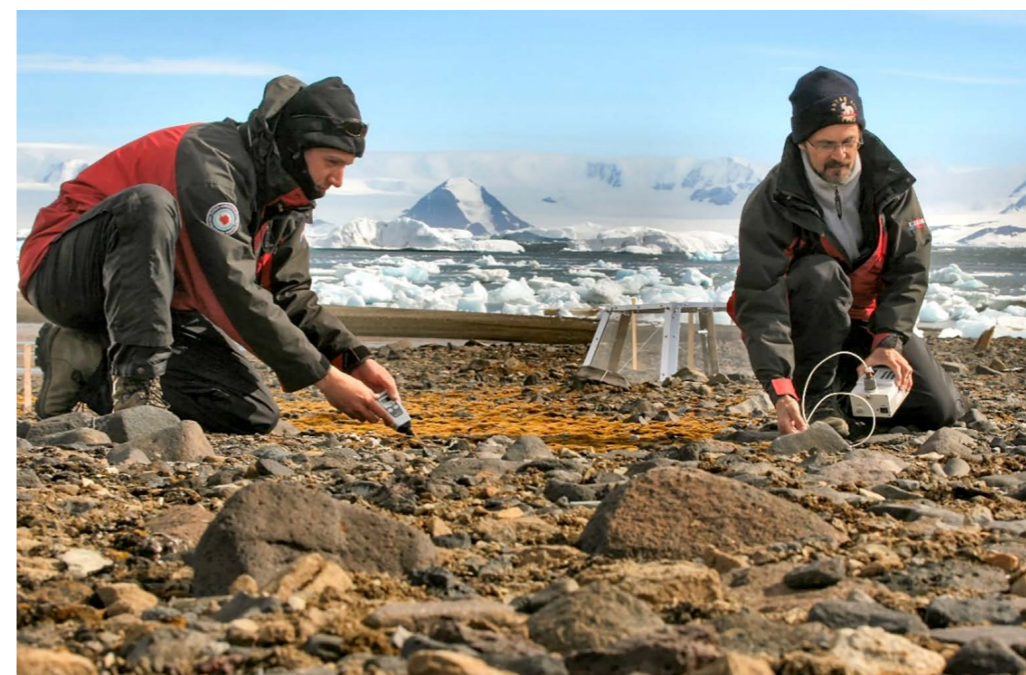
Měření indukované fluorescence chlorofylu u lišejníků na ostrově James Ross (Antarktida). Vpravo vedoucí Laboratoře fotosyntetických procesů M. Barták.
