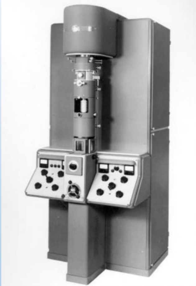
První transmisní elektronový mikroskop (TEM) v Brně [Bláha, Delong, Drahoš, Zobač, 1951], vyrobeno 25 kusů. Energie primárních elektronů: 50 keV, rozlišení 2 nm.
