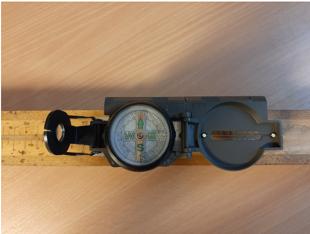
(a) Kompas na drevenej lavičke orientovanej kolmo k smeru H_z .
