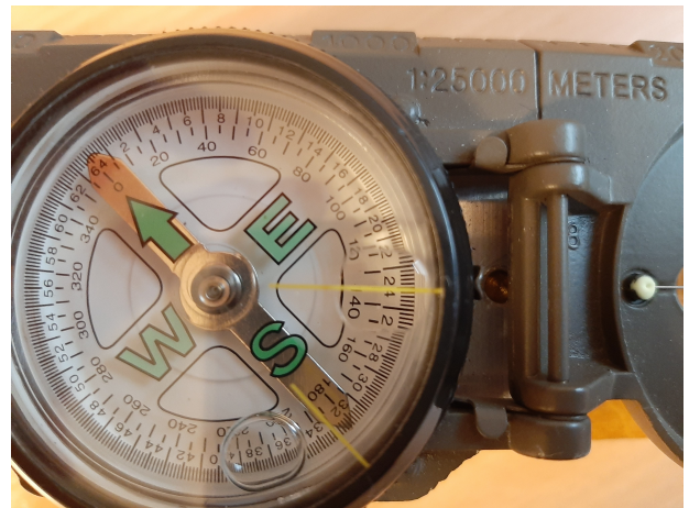
(d) Vychýlená strelka prislúchajúca polohe magnetu v Obr. 3c.
