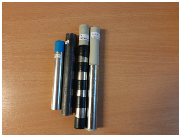
(b) Tieniace trubky, zľava nerez, oceľ, nikel, Fe-Si-B.
