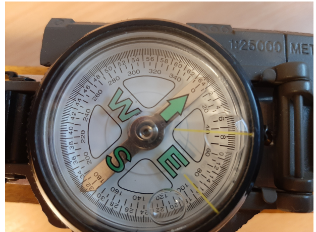
(b) Vychýlená strelka prislúchajúca polohe magnetu v Obr. 3a.
