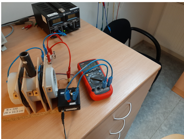
(a) Aparatúra so zasunutou tieniacou trebkou z ocele.
