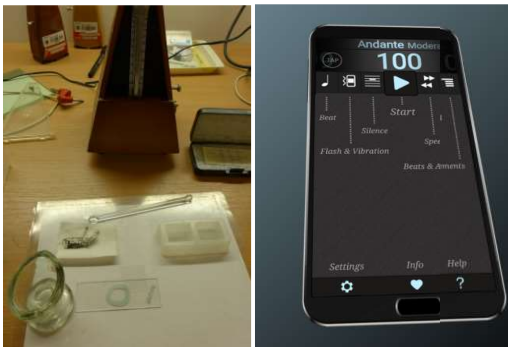
Obr. 9 Vlevo: Vzadu mechanický metronom, vpředu podložní a krycí sklíčka s tubou běloby a kapalinou jako prostředím pro částice. Vpravo: aplikace Metronomeros v chytrém telefonu, která může sloužit pro generování pravidelných zvukových pulsů za účelem zaznamenání polohy částic v daných aktuálních polohách.
