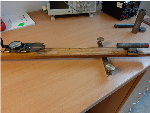
(c) Otočený magnet v prvej Gaussovej polohe vo vzdialenosti 45 cm.
