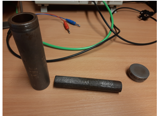
(b) Tyčový magnet s obalom tieniacim jeho magnetické pole.
