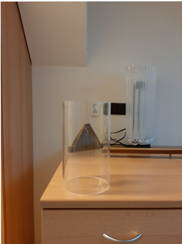
(a) Aparatúra na meranie periódy kmitov tyčvého magnetu v magnetickom poli Zeme.
