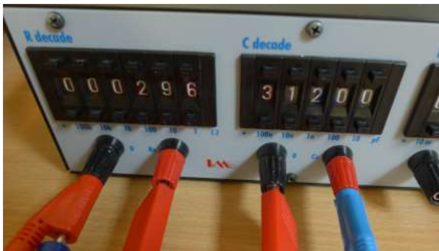
Obr. 3 Detail odporové (vlevo) a kapacitní (vpravo) dekády pro vyrovnávání odporu a kapacity roztoku mezi elektrodami v cele.
