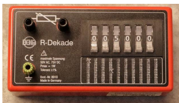
Obr. 2 Odporová dekáda s nastaveným odporom 5\ \text{k}\Omega .
