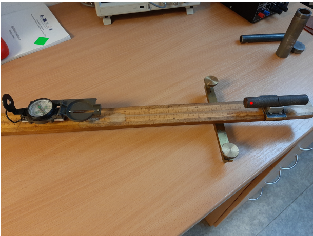
(a) Magnet v prvej Gaussovej polohe vo vzdialenosti 45 cm.
