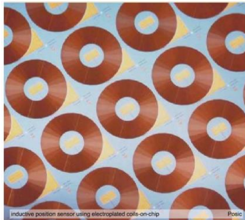
senzor s galvanicky nanesenými cívkami
