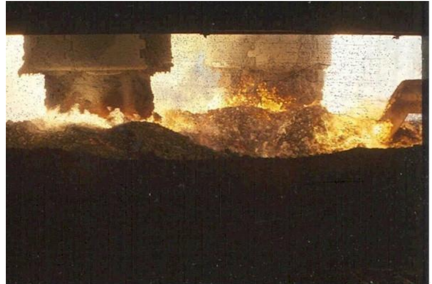
1 m široké oblúčkové elektródy v kontakte s Si rudou (kvarcit) a koksom
