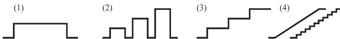
Obr. 22. Základní typy protokolů pro zátěžové testy: jednostupňové zvýšení (A), stupňované s přestávkami (B), stupňované bez přestávek (C), kontinuální (D)
