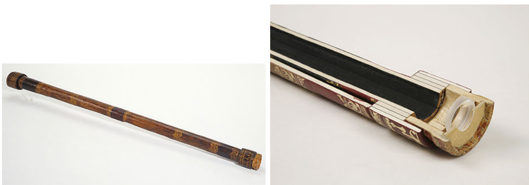
Obrázek 1.9: Vlevo: Galileův bohatě zdobený dalekohled. Vpravo: Řez replikou Galileova dalekohledu, která ukazuje strukturu a složení částí dalekohledu. Zdroj: http://blogs.telegraph.co.uk ; http://brunelleschi.imss.fi.it/galileopalazzostrozzi/ .
