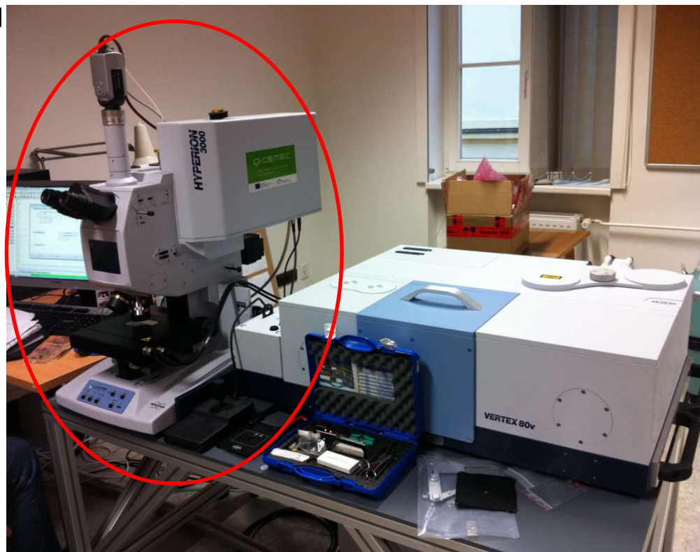
Infračervený mikroskop Bruker Hyperion 3000 (CEITEC)
