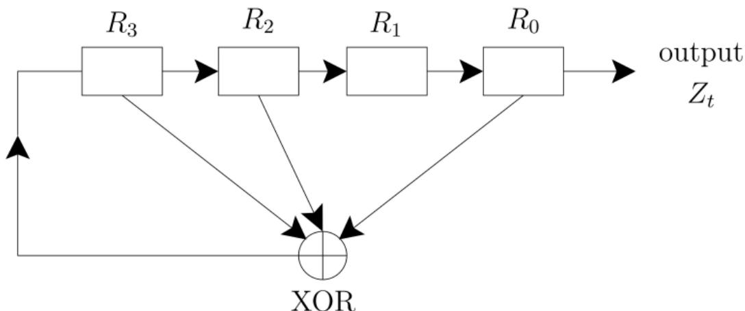
**Lineární posouvací registr s charakteristickým polynomem**
