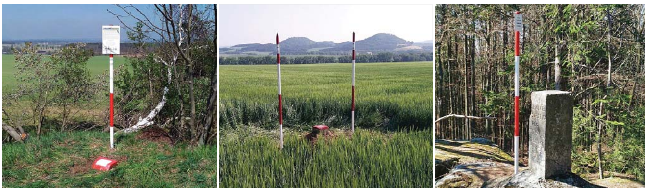
Ukázka bodů Základního bodového pole polohového: zleva bod č. 6 u obce Pleše, bod č. 18 u obce Bořitov, bod č. 22 u obce Soběnov
