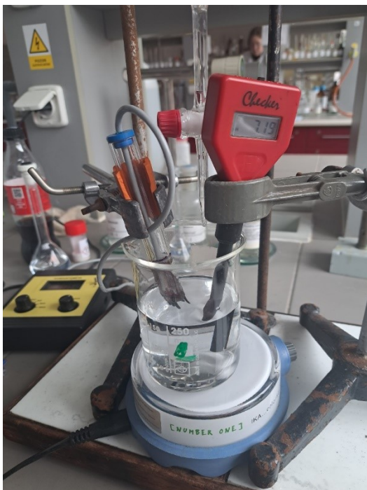
Obr. 18: Sestava pro současnou indikaci bodu ekvivalence pomocí konduktometrie a potenciometrie
