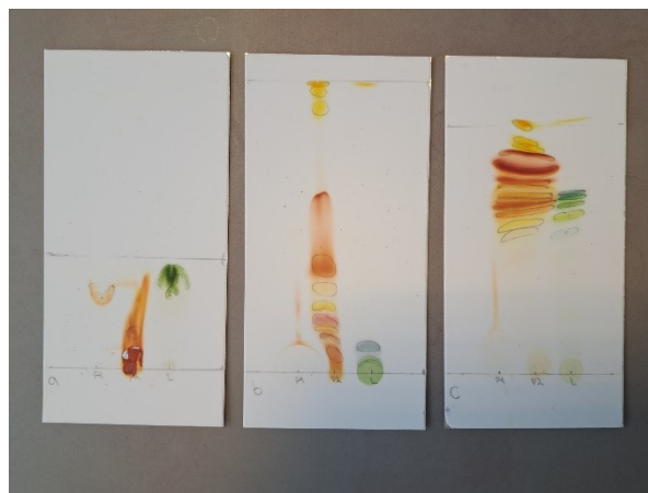
Obr. 19: Schéma TLC destičky a příklady s rozděleným rostlinným vzorkem
