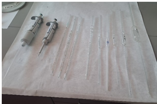
Obr. 6: Příklady mikropipet a skleněných dělených a nedělených pipet
