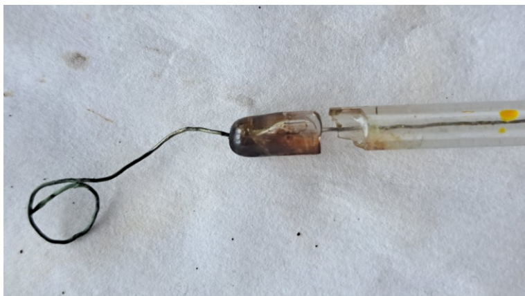
Obr. 4: Prasklá tyčinka Pt drátku po jejím vložení do plamene kahanu
