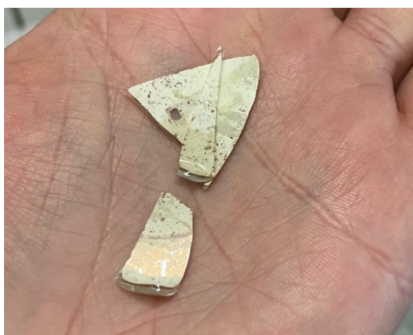
Obr. 78: Stříbrné elektrody vyrobené postříbřením Petriho misky pomocí Tollensova činidla a formaldehydu.
