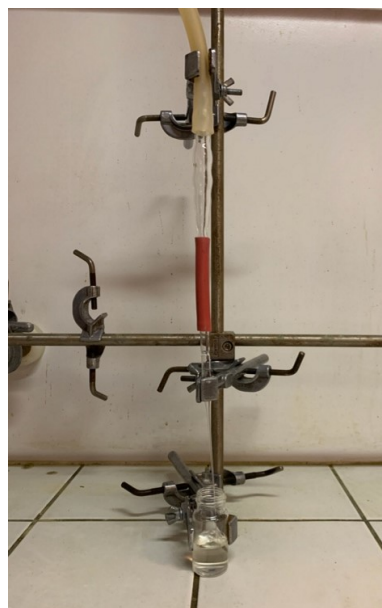
Obrázek 32: Extrakce emulze diethyletherem (vlevo) a odpařování rozpouštědla z extraktu proudem dusíku (vpravo).
