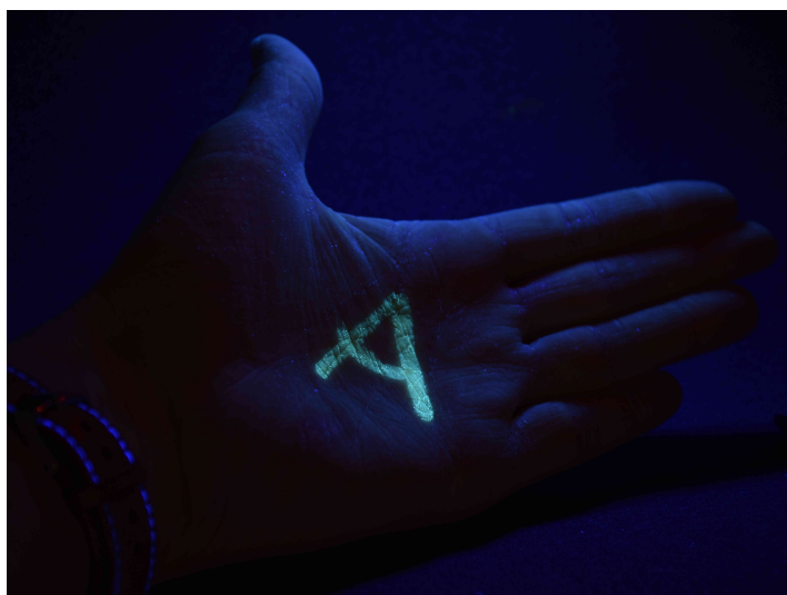
Obr 26: Fluorescence připravených biokompatibilních uhlíkových nanočástic při 366 nm.
