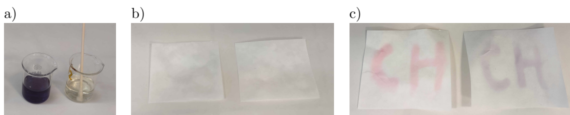
Obr. 10: (a) Vodný extrakt z červeného zelí (levá kádinka) odbarvený roztokem disiřičitanu sodného (pravá kádinka); (b) suchý nápis odbarveným extraktem na filtračním papíře; (c) vizualizace nápisů 10% roztokem kyseliny citronové (vlevo) a 10% roztokem síranu draselno-hlinitého.
