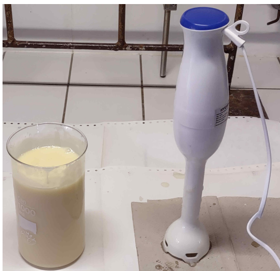
Obr. 38: Směs rostlinných tuků a roztoku NaOH po promíslení pomocí tyčového mixéru.
