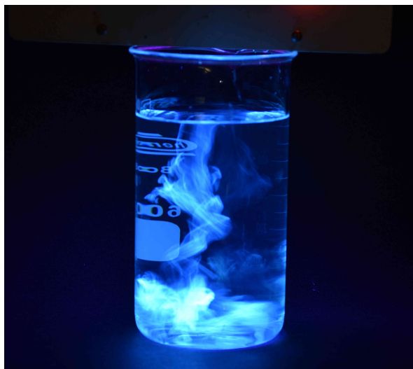
Obr 25: Fluorescence připravených uhlíkových nanočástic při 366 nm.
