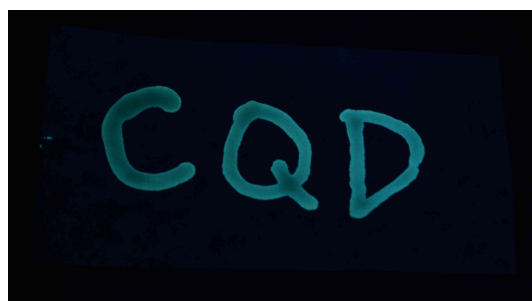
Obr 27: Nápis provedený roztokem CQD ve viditelném světle (vlevo) a pod UV lampou při 366 nm (vpravo).
