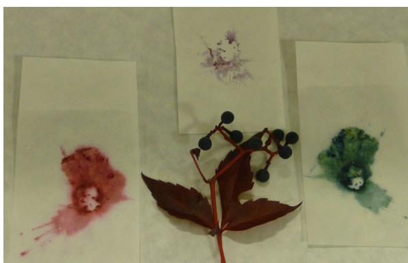
Obr. 6: Reakce antokyanů obsažených v červeném zelí (A), ředkvičce (B), červeném listu rostliny (C) a modré bobuli stejné rostliny (D) na pH. Papírek vlevo má kyselou reakci, uprostřed je neutrální pH, vpravo bazické pH.
