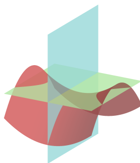
Obrázek 24.6: Řezy hyperbolického paraboloidu
