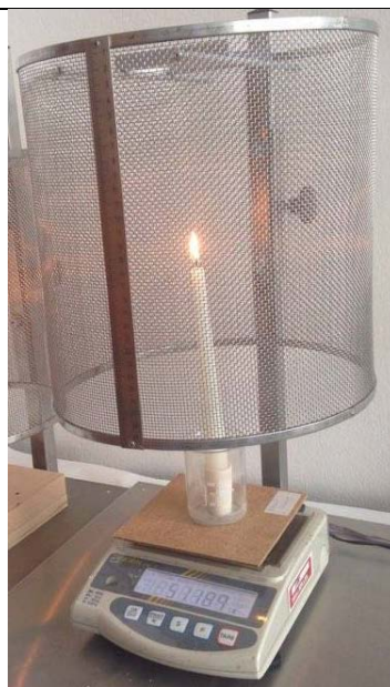
Obr. 33 – Stanovenie hmotnostného úbytku vzorky
