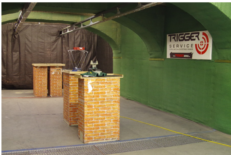
Obr. 3 – Pracoviště pro měření rychlostí střel [vlastní zdroj]
