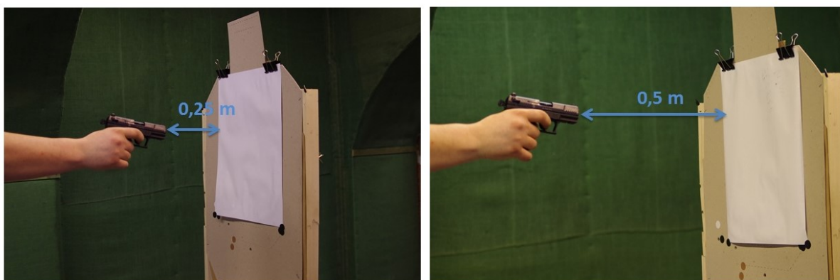
Obr. 4 – Pracoviště k měření povýstřelových zplodin expanzní zbraně na vzdálenosti 0,25 a 0,5 metru [vlastní zdroj]
