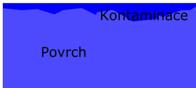
Obr. 1 – Kontaminace povrchu bývá často nehomogenní a je nutné odstranění povrchu podle nejhůře zasažených částí.
