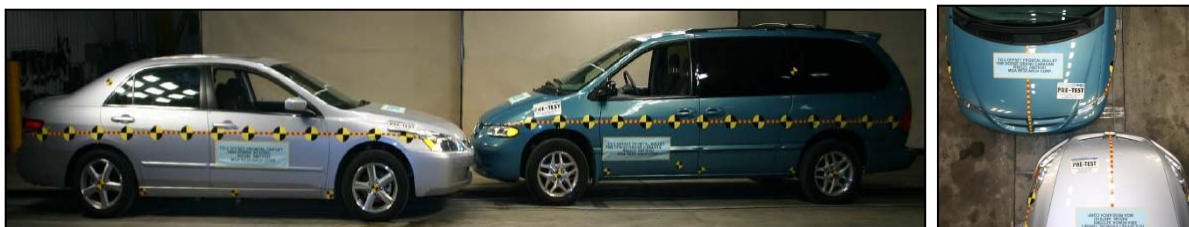
Obr. 17- Střetová konfigurace čelní nárazové zkoušky Hondy Accord r.v. 2004 a Dodge Grand Caravan r.v. 1999 [14]
