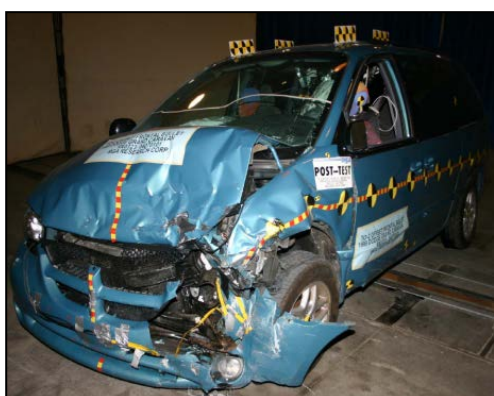
Obr. 19 - Dodge Grand Caravan po nárazové zkoušce [14]
