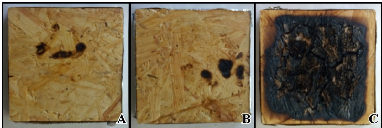
Obr. 4 – OSB s aplikovaným etanolom po skúške pri tepelnom toku: A = 0 kW.m -2 ; B = 5 kW.m -2 ; C = 10 kW.m -2
