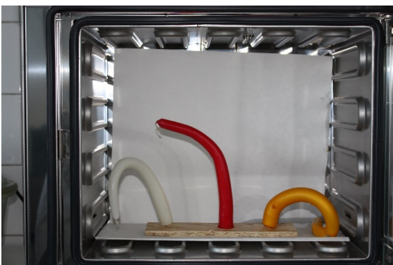
Obr. 41 Deformácie pri 55 °C v čase 35 min.
