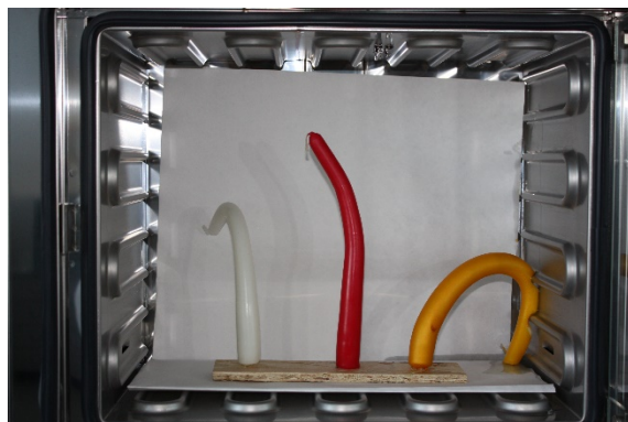
Obr. 40 Deformácie pri 50 °C v čase 35 min.
