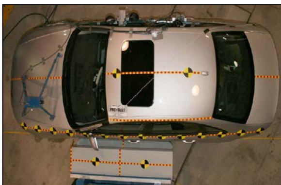
Obr. 11 - Nárazová zkouška bočního nárazu vozidla Audi A4 2009 [14] Fig. 11 – Side Crash test of Audi A4 2009 [14]
