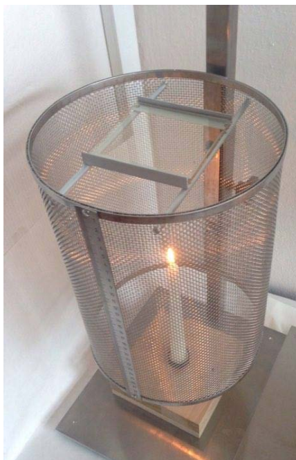
Obr. 34 – Sítový cylinder zo zapálenou vzorkou, stanovenie indexu sadzí Fig. 2 - Wire mesh cylinder with lit sample, determination of soot index
