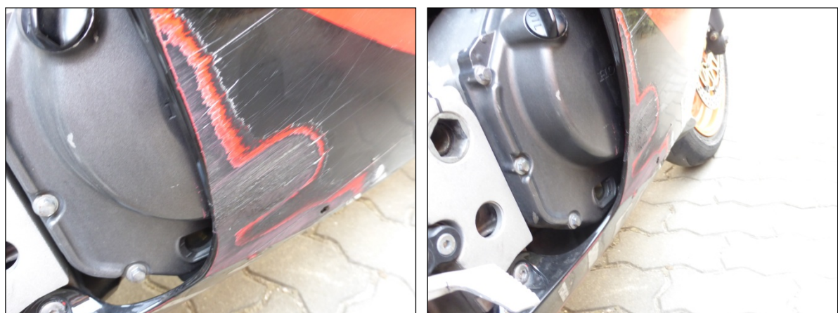
Obr. 32, 33 – Detail poškození kapotáže na pravém boku předmětného motocyklu, zmenšená tloušťka
