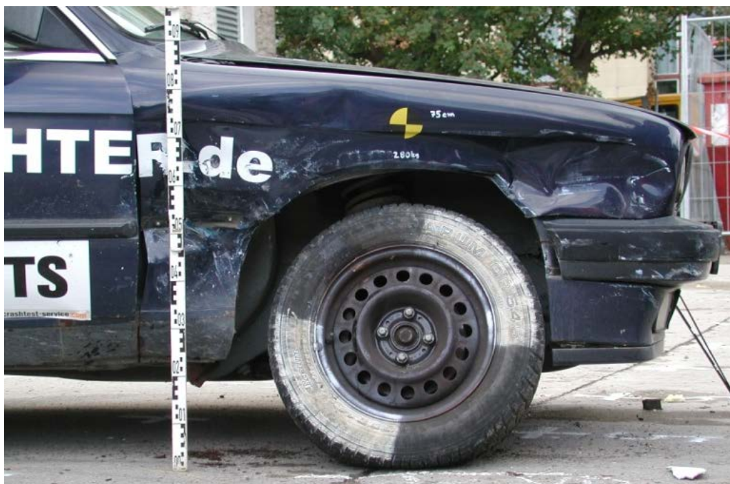
Obr. 5 – Příklad souhrnného snímku poškozené oblasti vozidla - nárazová zkouška, [6] Fig. 5 – Example of overview image of damaged vehicle area - crashtest, [6]
