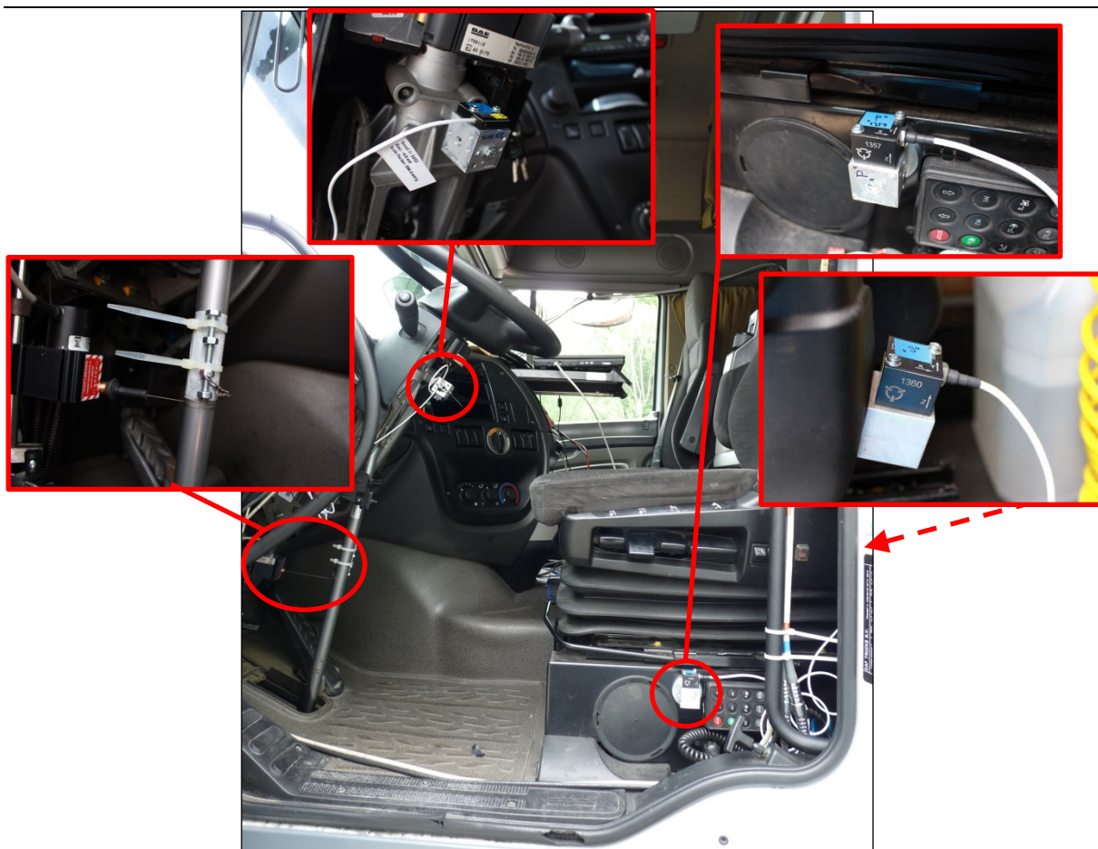
Obr. 3 – Měřící místa v kabině vozidla Fig. 3 – Measuring points in the cab
