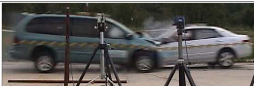
Obr. 18 - Čelní nárazová zkouška stojící Hondy Accord a protijedoucího Dodge Grand Caravan [14]
