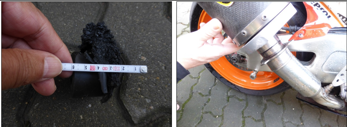
Obr. 28, 29 – Detail poškození padacího protektoru, zkrácení cca 3 cm, poškození příruby tlumiče výfuku
