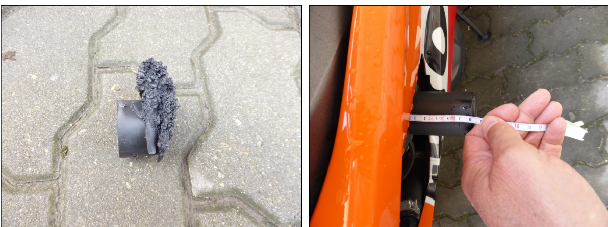
Obr. 26, 27 – Sedřený a natavený padací protektor, nepoškozený má délku 6 cm
