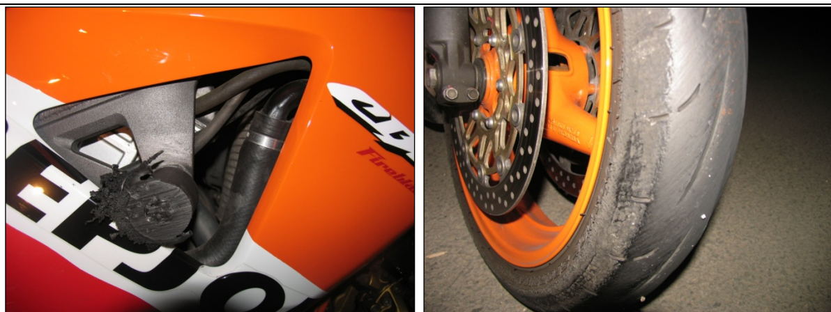
Obr. 22, 23 – Detail poškození padacího protektoru a sedření pravého boku přední pneumatiky motocyklu
