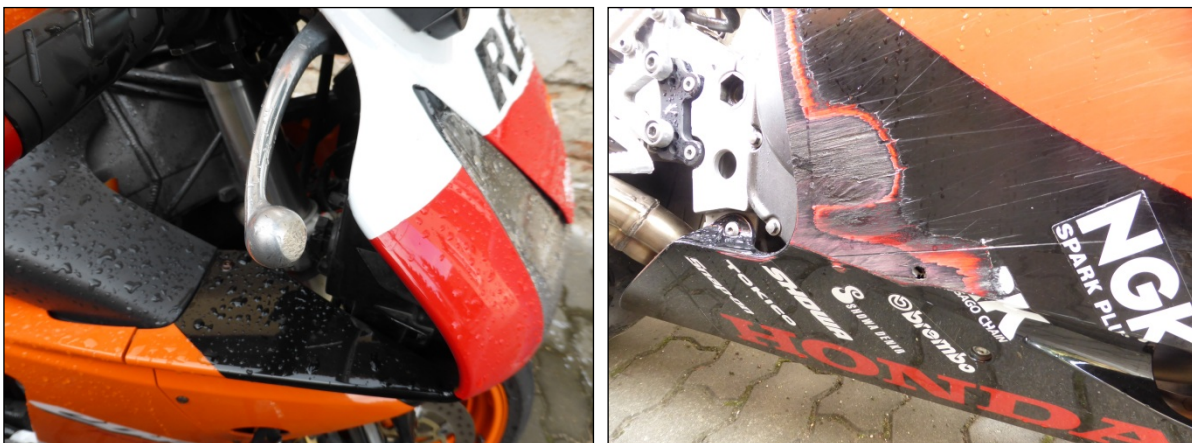
Obr. 24, 25 – Detail poškození páčky brzdy a kapotáže na pravém boku motocyklu
