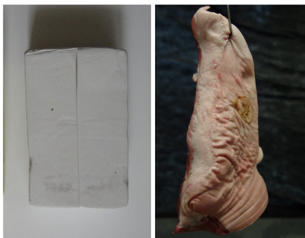
Obr. 5 - Náhradní materiál (plastelína) a měkká tkáň (vepřové maso s kůží) [vlastní zdroj]
