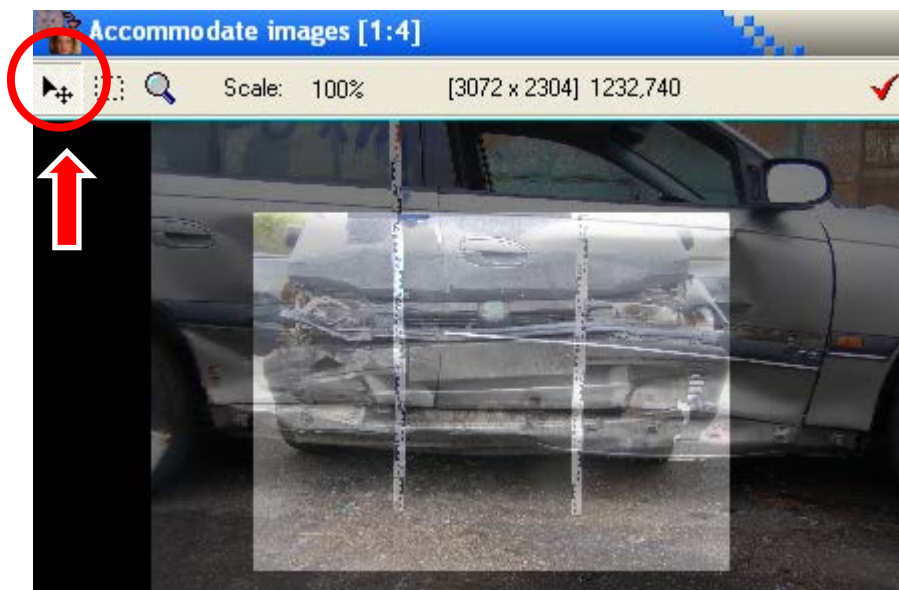
Obr. 14 – Ustavení bodu kontaktu: „Image“, „Accommodate images“ a „Move image“ Fig. 14 – Provision of contact point: „Image“, „Accommodate images“ and „Move image“
