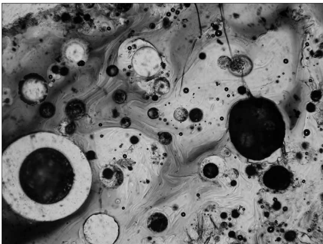
Obr. 8: Fluidální mikrostruktura s kruhovými póry, 10x, PPL.
