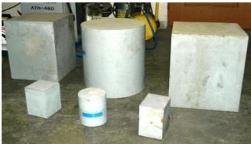
Obrázok 1: Skúšobné telesá pre úplný i čiastočný prielom
