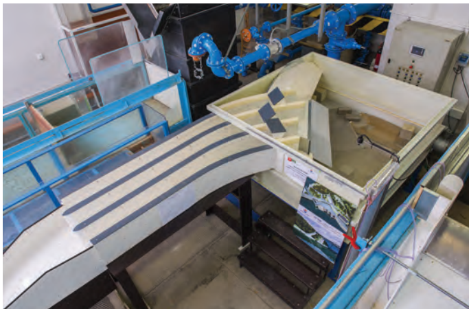
Obr. 3. Horní pohled na ukliďňovací nádrž, vtokový objekt a navazující část skluzu
