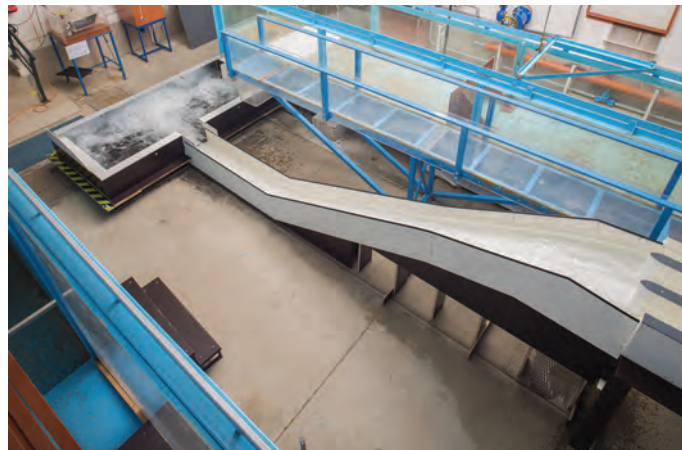
Obr. 4. Horní pohled na model otevřené části skluzu a odpadní nádrž
