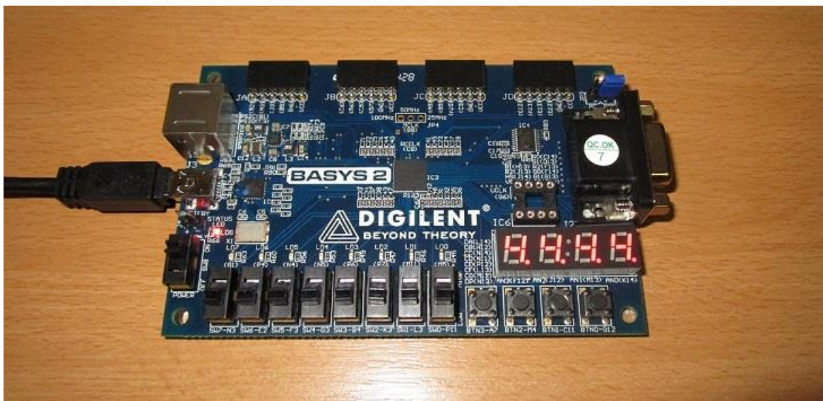
Obr. 5.1.1 Ukázka vývojového kitu Digilent Basys 2
