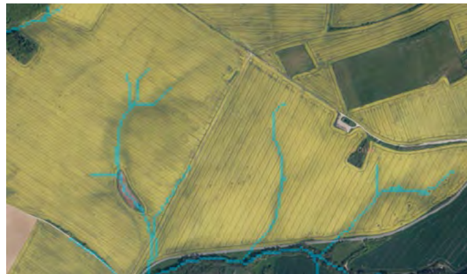
Obr. 3. Příklad identifikace DSO na ortofotomapě s využitím hydrologických nástrojů GIS
