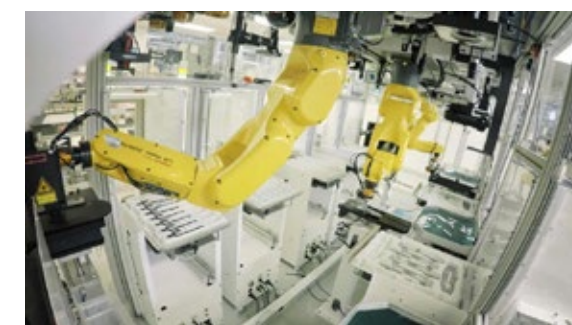
Im Reinraum garantieren Roboter bei der Fertigung medizinischer Produkte ein hohes Maß an Sauberkeit und Sterilität (Quelle: Plexus)
