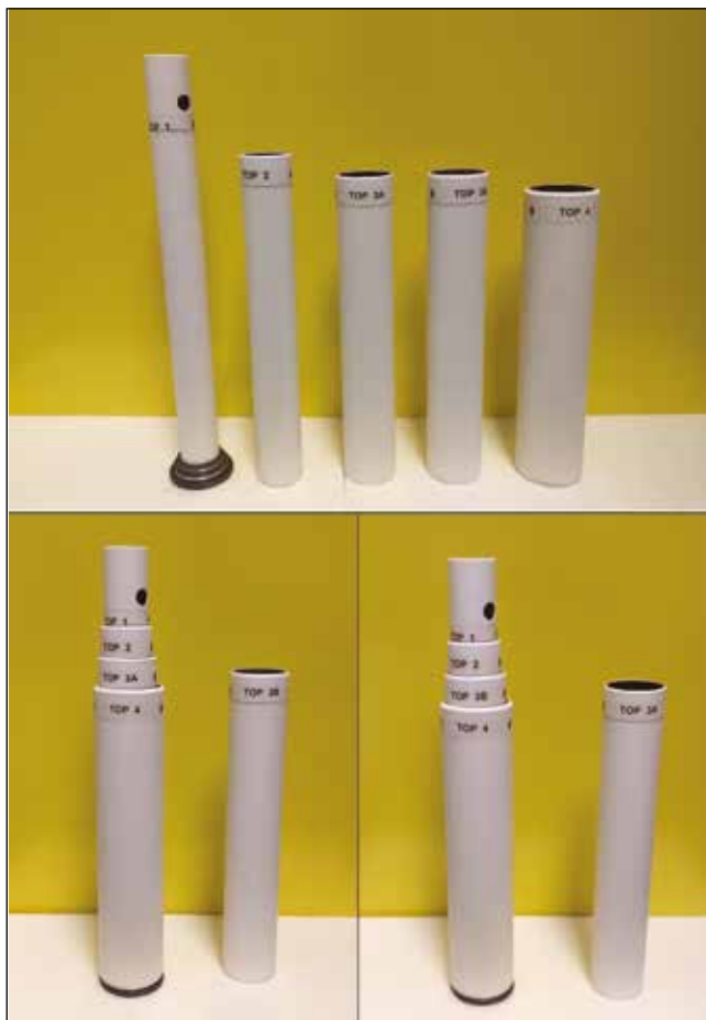
Obr. 1 Lineátor (Biodex). 5 oddělených trubic lineátoru 1, 2, 3A, 3B, 4 (nahore), do sebe zasunuté trubice 1, 2, 3A, 4 a zbylá trubice 3B (vlevo dole), do sebe zasunuté trubice 1, 2, 3B, 4 a zbylá trubice 3A (vpravo dole). TOP je označení horní části trubice.
