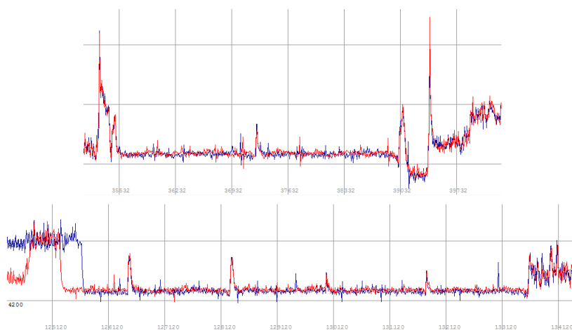
Obrázek 7.4: Výřez počátku (nahore) a konce (dole) šifrovací oblasti s výraznou podobností dvou stop pocházejících z různých měření.
