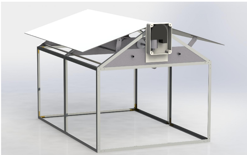
Obrázek 7 – 3D model výsledného skleníku při otevřené střeše
