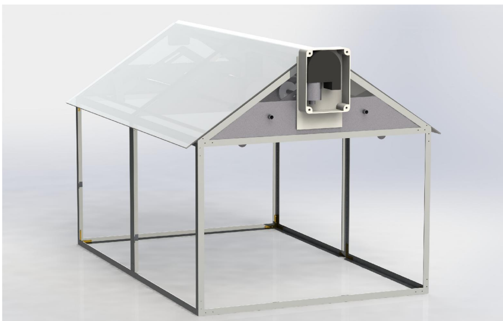
Obrázek 6 – 3D model výsledného skleníku při zavřené střeše
